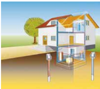
Anlagenschema - Förder- und Schluckbrunnen Wasser
